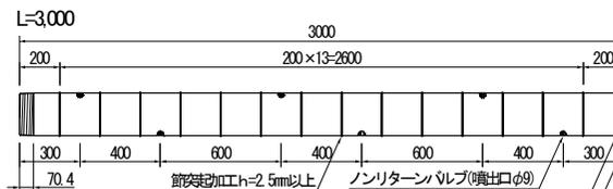
フーチング下端位置 節突加工h=2.5mm以上 ノンリターンバルブ(真出口φ9) 70.4
