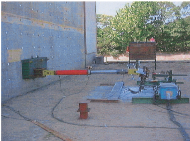
■水平交番載荷試験状況
