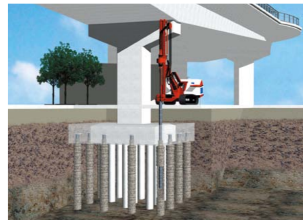
橋梁基礎の耐震補強
