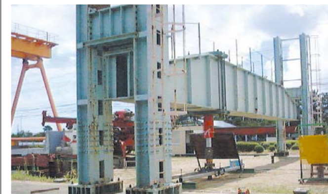
押し込み載荷試験
