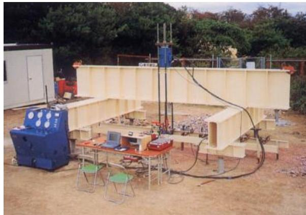
図-2.3.32 鉛直載荷試験状況<sup>7)</sup>
