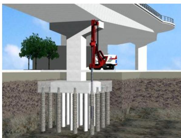
図-2.2.2 既設構造物基礎の補強増し杭<sup>2)</sup>
