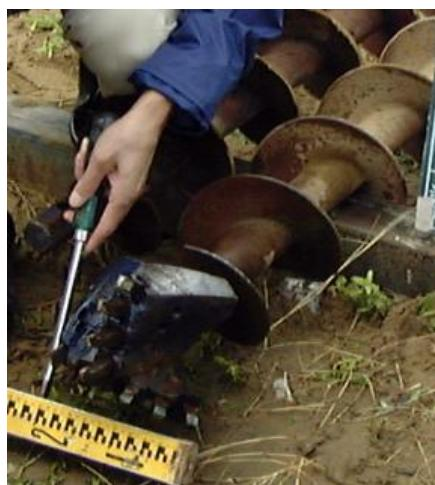
図-2.4.9 オーガー先端ビット例
