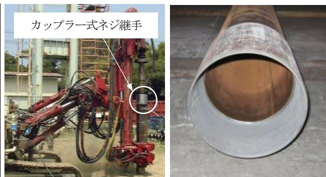
図-2.5.1 カッpler式ネジ継手の一例
