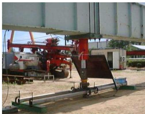
図-2.4.21 鉛直押込み載荷試験状況
