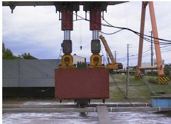
図-2.4.22 鉛直引抜き載荷試験状況
