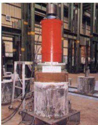
図-2.5.3 節突起付き鋼管の付着性能試験
