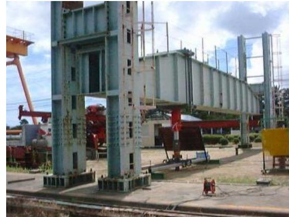
図-2.3.33 鉛直載荷試験状況<sup>8)</sup>
