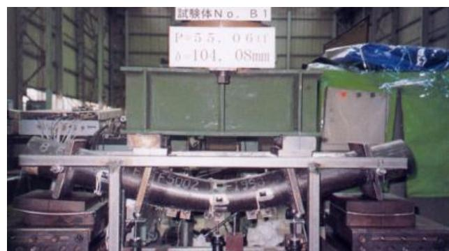
図-2.5.4 鋼管（継手有無）の曲げ試験
