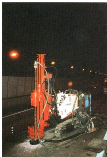
図-2.6.3 削孔機械 SM-103HD
