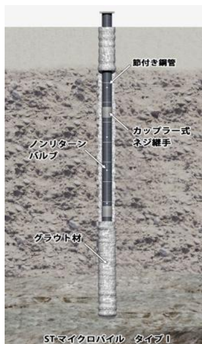
図-1.1.1 ST マイクロパイル工法 タイプ I 概要図
