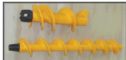
写真-2.3.10 オガーロッド (二重管削孔ツール)
