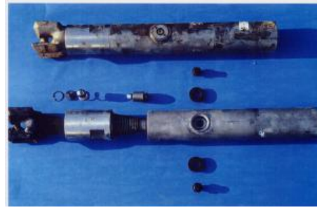
写真-2.3.4 改良体造成ツール
