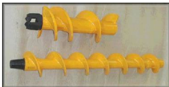
写真-1.3.7 回転式削孔ツール
