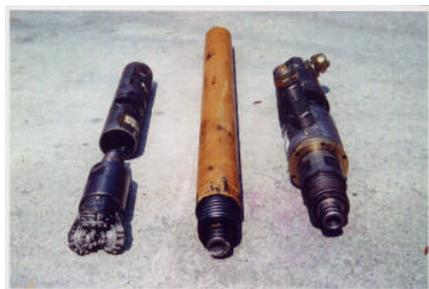
図-1.2.4 G T M工法のモニター・造成ロッド
