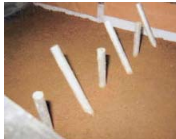
模型抑止杭の設置状況(千鳥配列)
