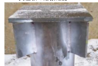
支圧板の溶接確認
