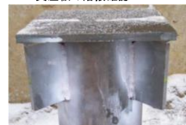
支圧板の溶接確認
