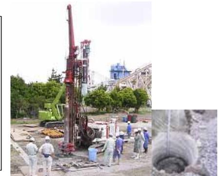
コンクリート削孔実験
