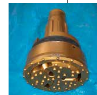
ダウンザホールハンマー方式の削孔システム
