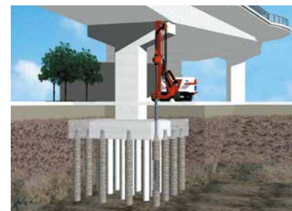
橋梁基礎の耐震補強
