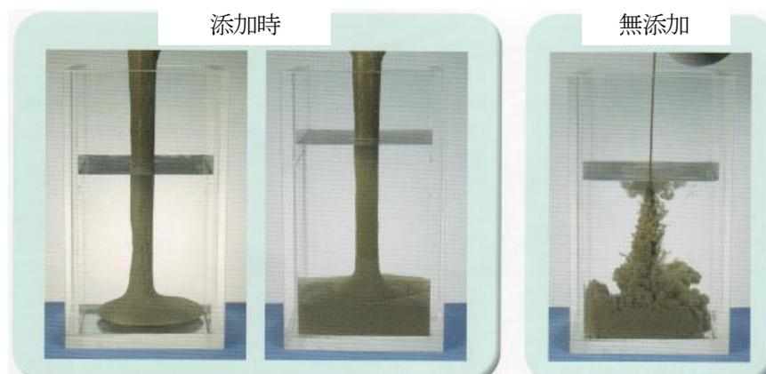
図-解 2.3.2 特殊混和剤の水中不分離性確認試験
