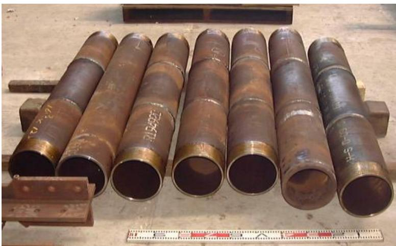
図-解 5.4.1 鋼管（ケーシング）：鋼管径 216.3mm, L=1.5m
