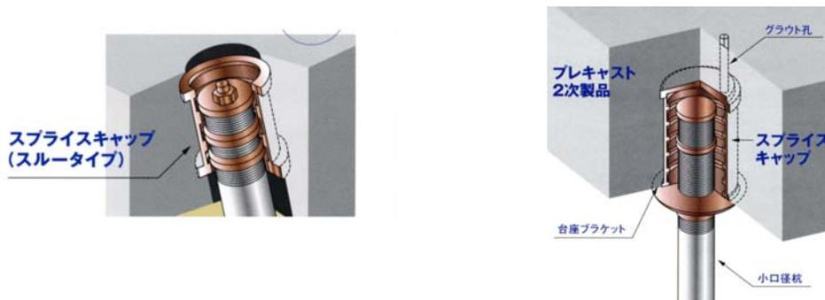
図-3.9.1 スプライスカップ工法の概念図
