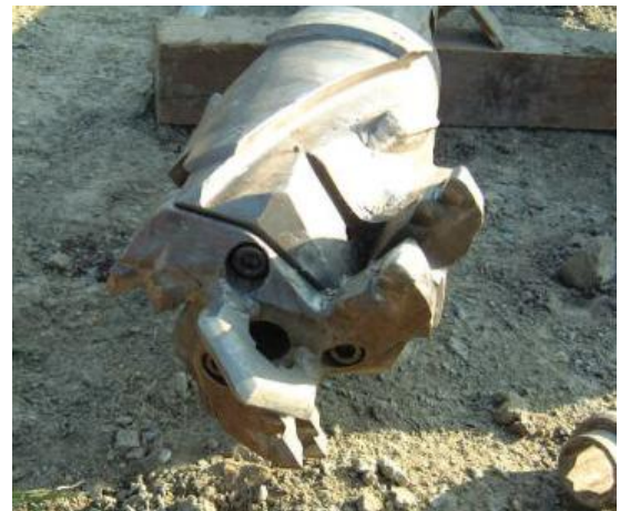
図-解 5.4.4 切削拡径ビット（拡径時）
