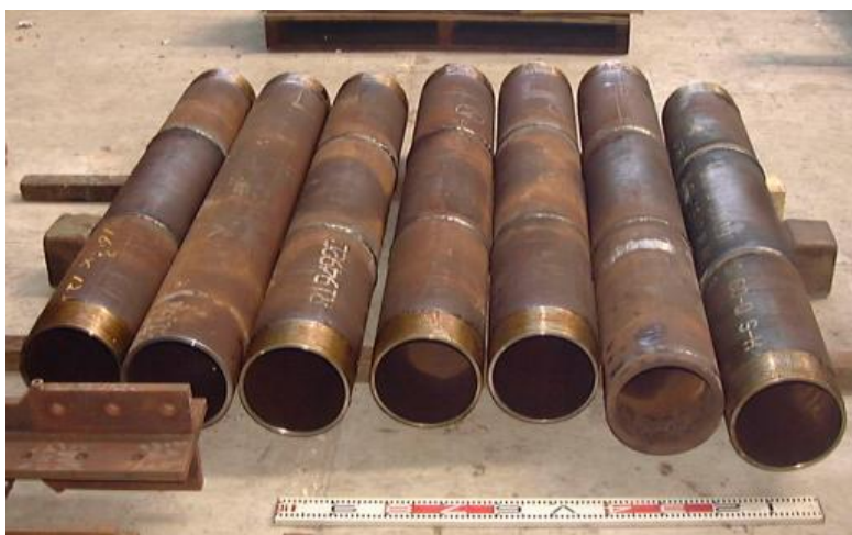
図-解 5.5.1 鋼管：鋼管径 216.3mm, L=1.5m
