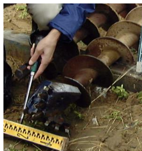
図-解 5.4.2 オーガー先端削孔ビットの一例
