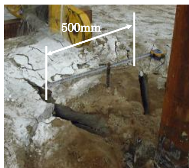
図-解 3.4.5 試験後の杭頭近影
